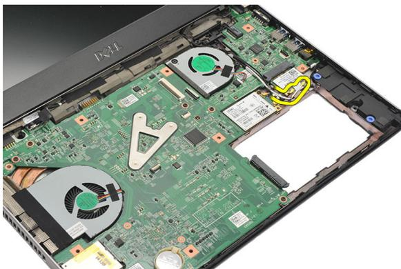
8. 拧下将 WLAN 卡固定至系统板的螺钉。
