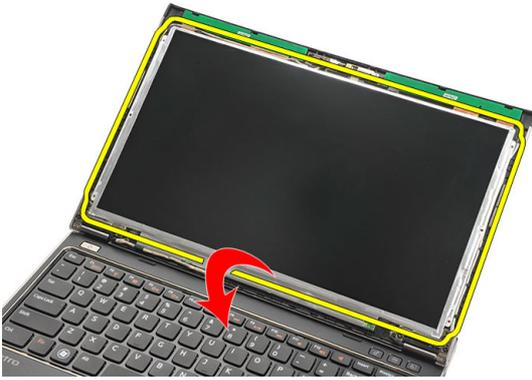
12. 剥下将低压差分信号 (LVDS) 连接固定到显示屏面板的胶带。
