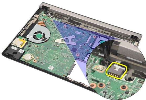
14. 拧下将系统板固定至机箱的螺钉。
