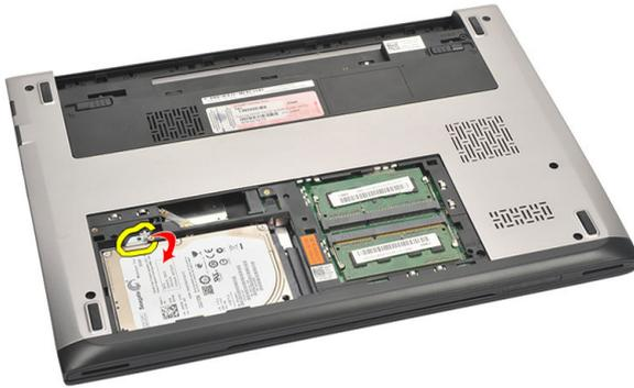
7. 卸下将硬盘驱动器支架固定至硬盘驱动器的螺钉。从硬盘驱动器上取下硬盘驱动器支架。
