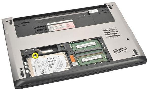
5. 将硬盘驱动器模块向左侧滑动。
