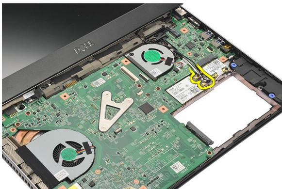
8. 拧下将 WWAN 卡固定至系统板的螺钉。
