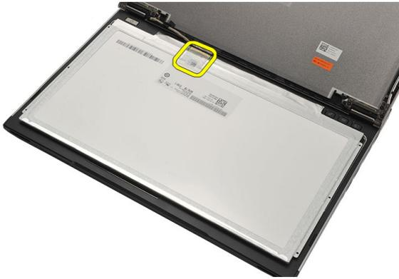
13. 断开 LVDS 电缆与显示屏面板的连接。
