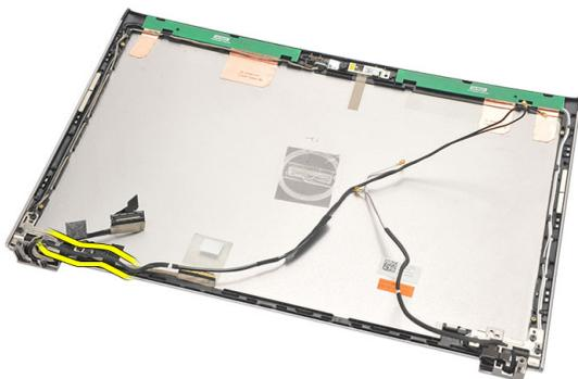
11. 从左侧显示屏铰接部件卸下低压差分信号 (LVDS) 电缆。
