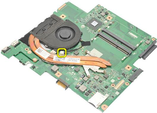
15. 松开将散热器固定到系统板上的固定螺钉。
