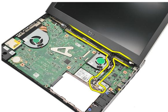
9. 从计算机上断开显示屏电缆的连接，从布线槽中将电缆取出。
